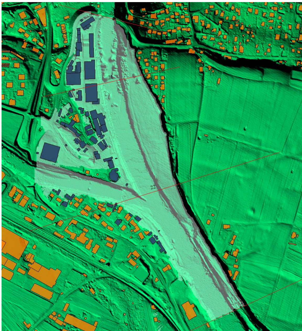
Slika 9: Približni prikaz območja maksimalnega poplavnega vala (2D aproksimacija razlitja), kot je izračunan v enodimenzijski 1D študiji (R.Rajar 1973). Objekti, ki bi jih dosegel poplavni val so označeni z modro.
